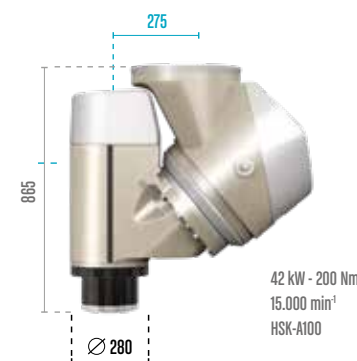
40°-Fräskopf mit Motorspindel Testa a 40° con elettromandrino
